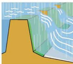
大雨のとき、ため池の水位が上昇し堤防を越えた水の勢いによって堤防が浸食され、決壊することがあります。竹や流木が洪水吐の断面を閉塞させると、堤防を越流しやすくなり、浸食・崩壊の危険性は、一層高くなります。
